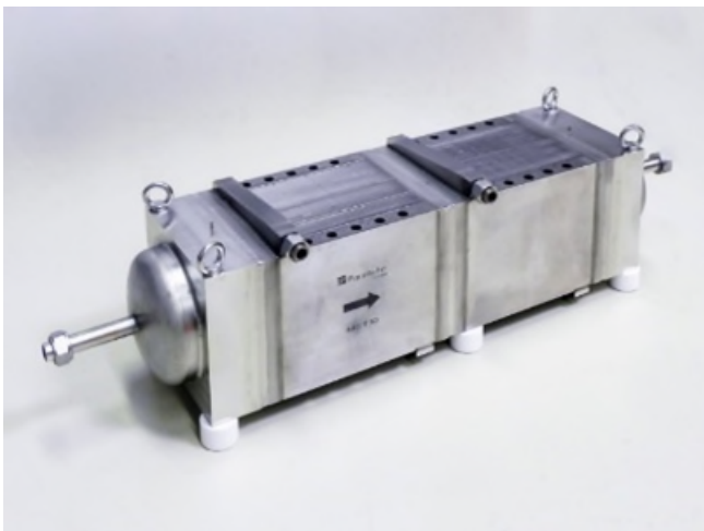
Abb. 1 Reaktor zur katalytischen Methanisierung von CO 2 , 50 kW Nennleistung.
